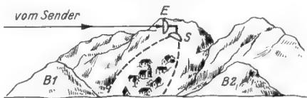
Bild 3. Längsverversorgung eines Tales
